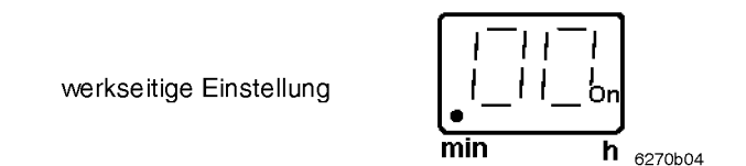
Abb. 12-5 Werkseitige Einstellung der Pausenzeit "P2" (Minuten)
